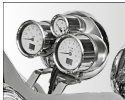
Modernes Instrumentencockpit: zeigt alle benötigten Informationen digital an, mit Diodentechnik.
