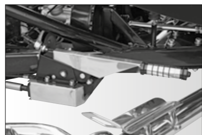
Handbremse: Edelstahlabdeckung und Edelstahlgriff.
